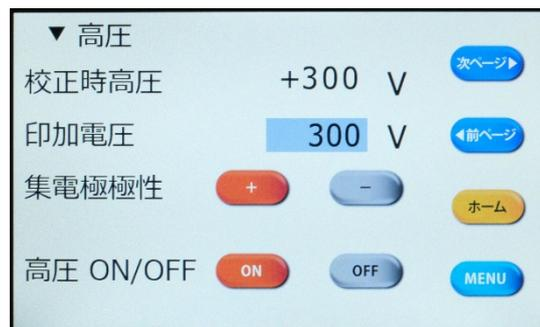
高圧 ON/OFF の ON ボタンを押すと印加開始
