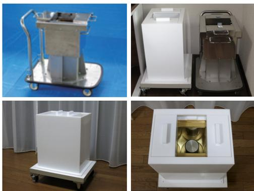
角型遮蔽体は厚さ50mmの鉛板で出来ています。内側には厚さ3~10mmの真鍮板を配置し、バックグラウンドの低減を図っています。
