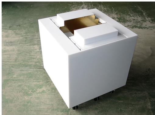
100-2L型遮蔽装置は厚さ100mmの鉛板+内側に厚さ6~10mmの真鍮板を配置しCsのバックグラウンドネットレートを鉛厚さ50mmの場合の1/2~1/3に低減しています。その効果でCsの測定下限(検出限界)が50mmの場合と比べ30~40%低減されました。
