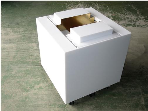
遮蔽装置は厚さ100mmの鉛板+内側に厚さ6~10mmの真鍮板を配置しCsのバックグラウンドネットレートを鉛厚さ50mmの場合の1/2~1/3に低減しています。その効果でCsの測定下限(検出限界)が50mmの場合と比べ30~40%低減されました。
