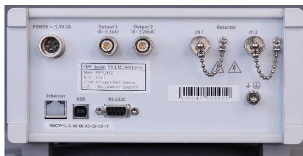
リア上部には左から電源・電荷出力・検出器の端子が並び、下部にはイーサネット・USB・RS232Cの端子が並びます。
