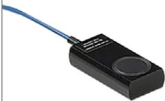
8 ~ 35keV の低エネルギー X 線測定に適した電離箱でマンモグラフィの測定に用いられます。
