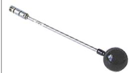
低線量率の直接線や散乱線の測定に用いられる球形で方向依存性の少ない電離箱です。
