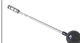
低線量率の直接線や散乱線の測定に用いられる球形で方向依存性の少ない電離箱です。
